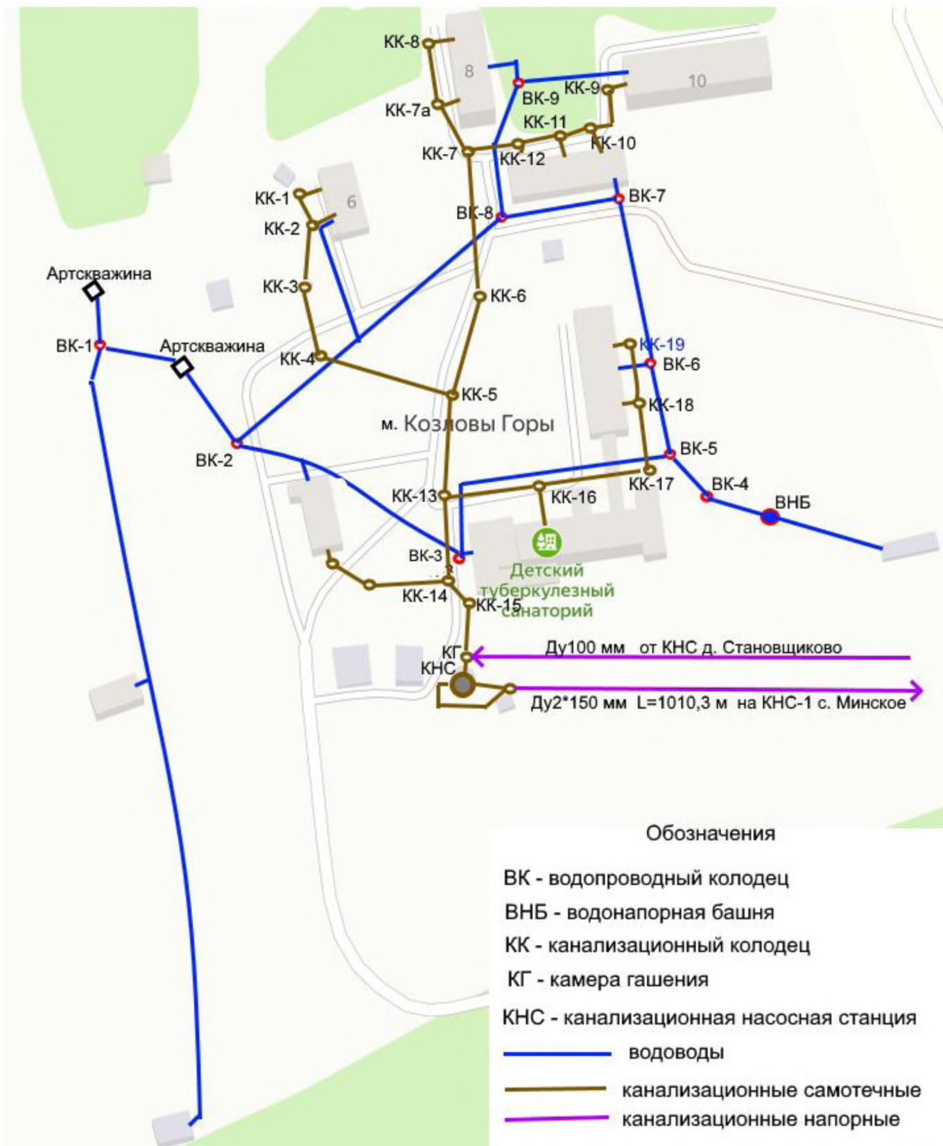
Рисунок 8.1.2 – Схема водопроводных и канализационных сетей м. Козловы Горы
