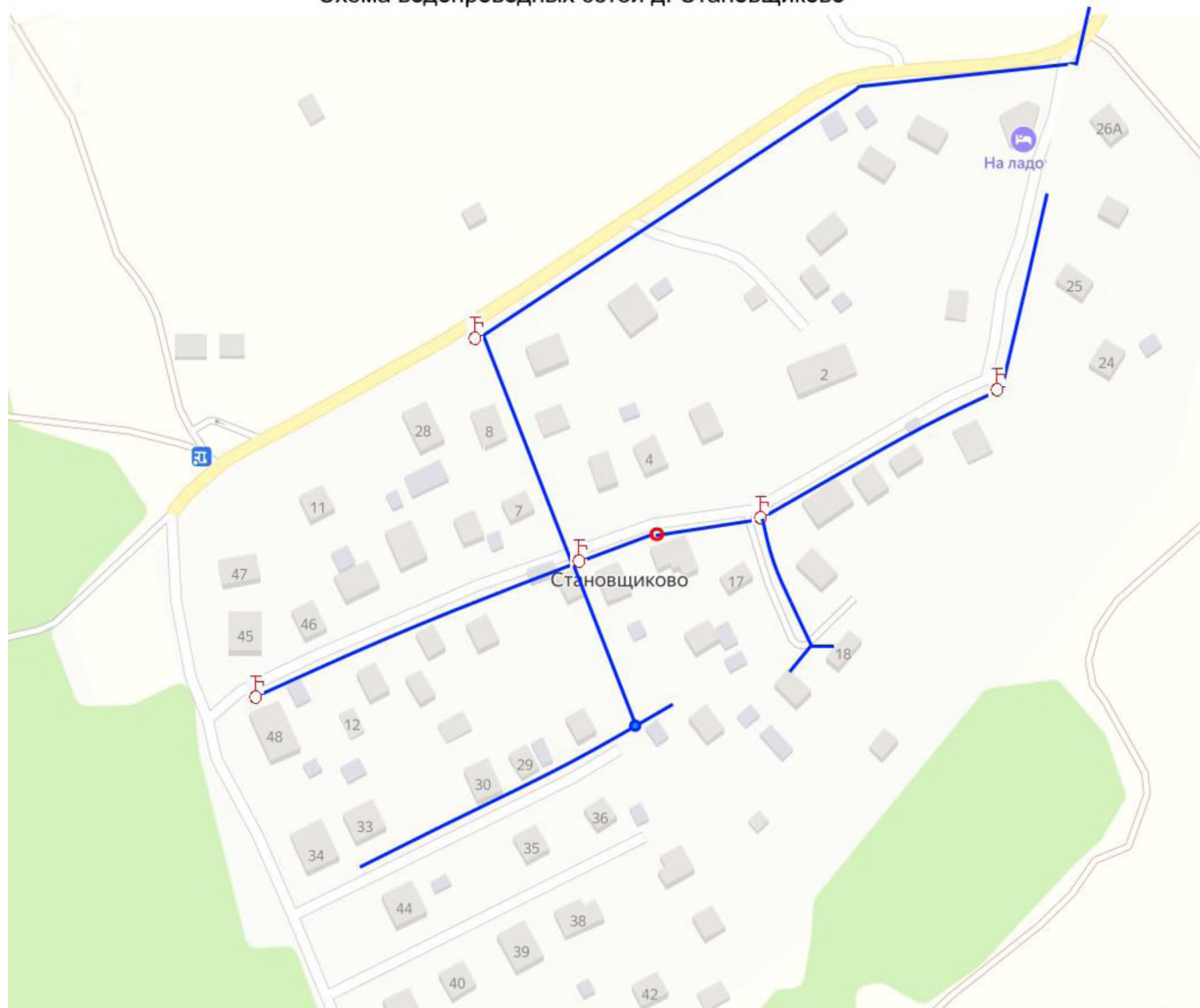
Схема водопроводных сетей д. Становщиково
