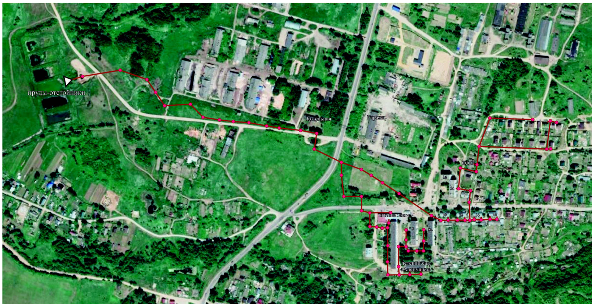
Рисунок 13 - Схема централизованного водоотведения в п. Апраксино
